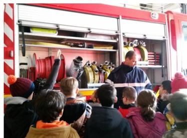
Le **FPT** : **Fourgon Pompe Tonne** qui contient des lances et des tuyaux pour se raccorder aux bornes à incendie mais qui a aussi une réserve d'eau à l'intérieur du camion mais aussi des cônes et triangles de signalisation. Il n'est pas utilisé que pour les incendies.
