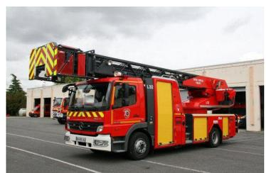
L'**EPA** : l'**Echelle Pivote Automatique** de 30 mètres.
